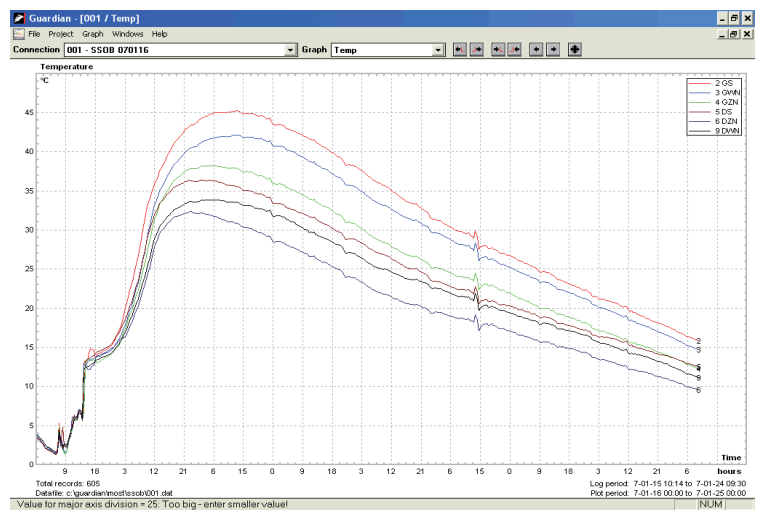
Rys. 5. Wyniki monitoringu przebiegu temperatury wewnątrz słupów głównych ramy o przekroju 0,80x1,80 m, przeprowadzonego w dniu 18 stycznia 2007 r.
