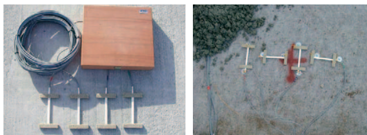
Fot. 3. Widok czujników do pomiarów odształceń
