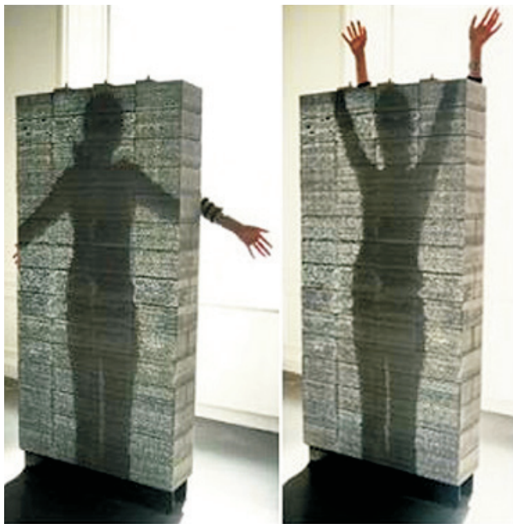
Rys. 4. Transparent concrete, LiTraCon – beton przepuszczający światło słoneczne. Źródło: www.techeblog.com
