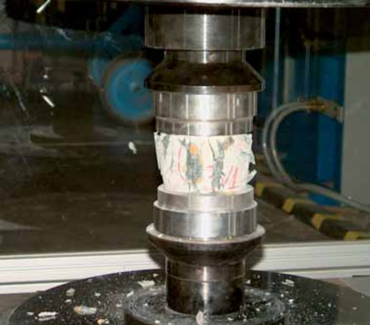
Rys. 6. Widok „prawidlowego” charakteru zniszczenia próbki walcowej
