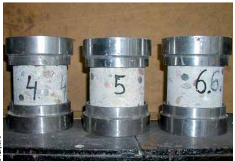
Rys. 5. Widok próbek z założonymi kapsłami piaskowymi
