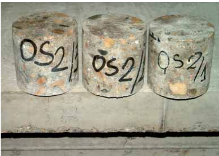
Rys. 4. Widok próbek przygotowanych do badań o długości równej średnicy ( h = \phi = 100 mm)
