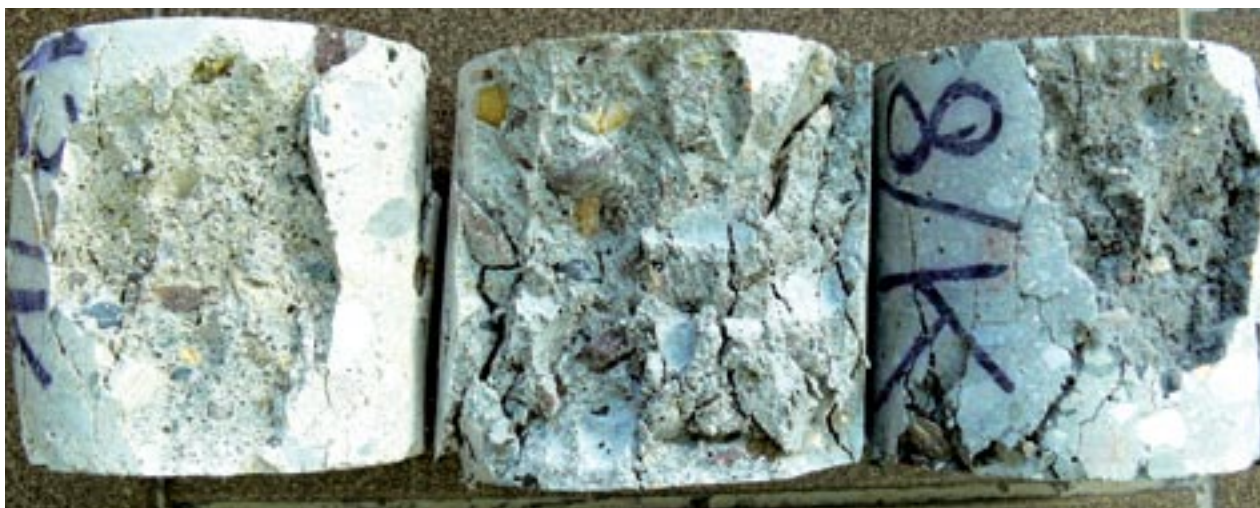
Rys. 6. Jedna posadzka (powyżej) i różne spoiwa do jej wykonania – każda z badanych próbek potwierdziła klasę wytrzymałości na ściskanie betonu C20/25 i tylko taką. Badany element wykazuje pęknięcia skurczowe charakterystyczne dla wysokiego wskaźnika w/c
