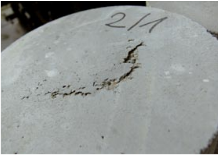
Rys. 4a. „Wysadzina” na powierzchni posadzki utwardzonej posypką mineralną
