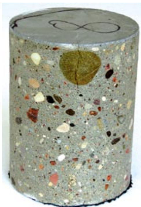
Rys. 2. Uziarnienie betonu o charakterystycznie wysokim punkcie piaskowym, wraz z rysą skurczową widoczną na próbce rdzeniowej średnicy 140 mm
