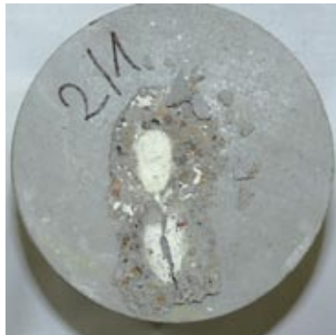
Rys. 4b. „Krater” z nietrwałym ziarnem kruszywa na powierzchni wyciętej z posadzki. Zobrazowanie wielkości uszkodzenia na tle powierzchni górnej rdzenia o średnicy 130 mm przypadku przedstawionego na rysunku 3
