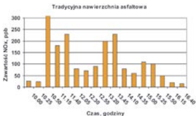
Rys. 6. Pomiar koncentracji tlenków azotu NO x w powietrzu – porównanie nawierzchni asfaltowej i nawierzchni z fotokatalitycznej kostki brukowej [8]
