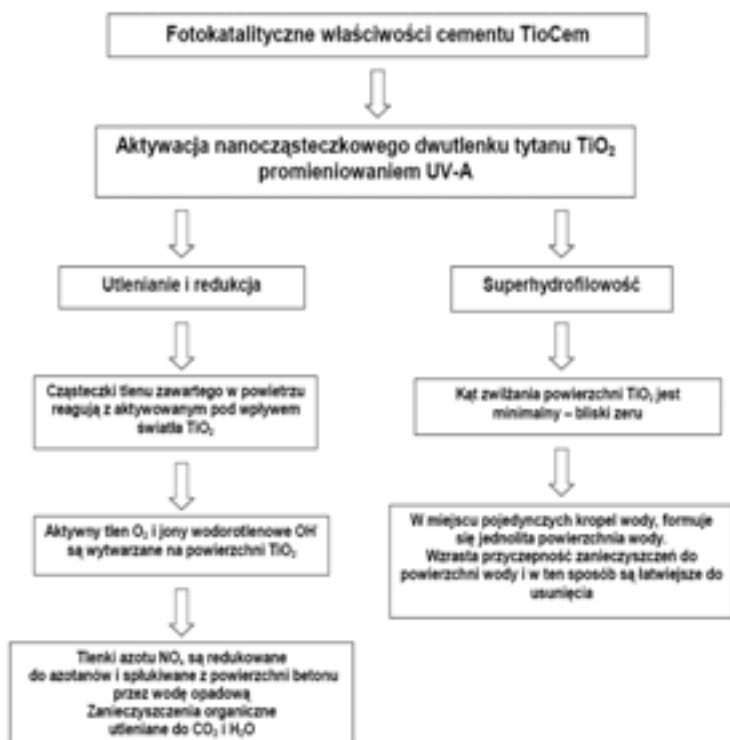
Rys.1. Właściwości fotokatalityczne cementu TioCem ® – schemat przebiegu procesów redukcji zanieczyszczeń zawartych w powietrzu i samoczyszczania betonu [2, 3]
