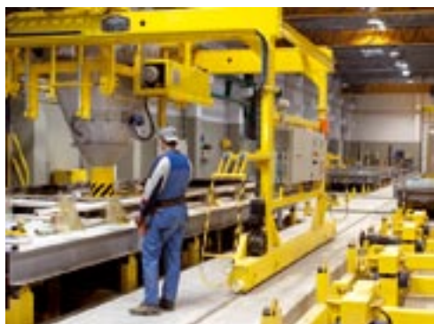
Fot. 4. Proces betonowania ścian, źródło: Elematic
