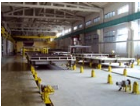
Fot. 5. Linia produkcyjna elementów płytowych/ściennych
