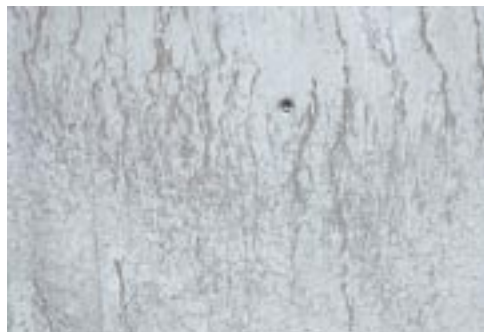
Fot. 2. Efekt niskiej lepkości i rozsegregowania mieszanki
