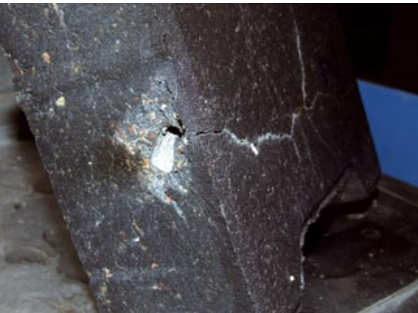
Fot. 3. Uszkodzenia kostki brukowej spowodowane pęcznieniem kruszywa grubego podczas cyklicznego zamrażania i rozmrażania. Spękania warstwy licowej
