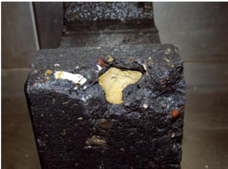
Fot. 5. Uszkodzenia kostki brukowej spowodowane pęcznieniem kruszywa grubego podczas cyklicznego zamrażania i rozmrażania. Ubytek krawędzi bocznej spowodowany pęcznieniem i rozpadem ziarna kruszywa
