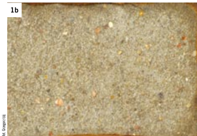
Rys. 1b. Próbką wykonana na cemencie CEM I 42,5R po ocenie odporności na zamrażanie/rozmarzanie z udziałem soli odladzających (ubytek masy 0,43 kg/m 2 )
