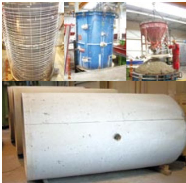
Rys. 3. Proces produkcyjny rur „High Performance Pipe”
