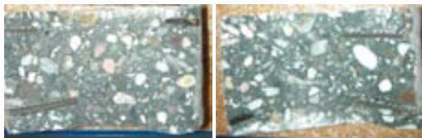
Rys. 4. Głębokość penetracji wody pod ciśnieniem (widoczny brak penetracji wody)
