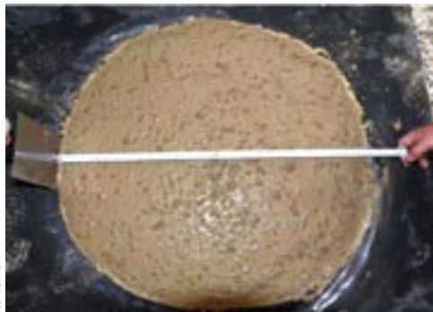
Fot. 8. Kontrola rozplywu betonu
