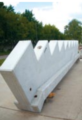
Fot. 10. Belka zębata wykonana w technologii SCC
