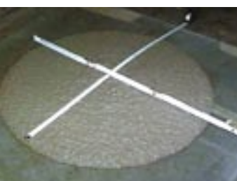
Fot. 2. Pomiar rozplywu na stoliku wstrząsowym
