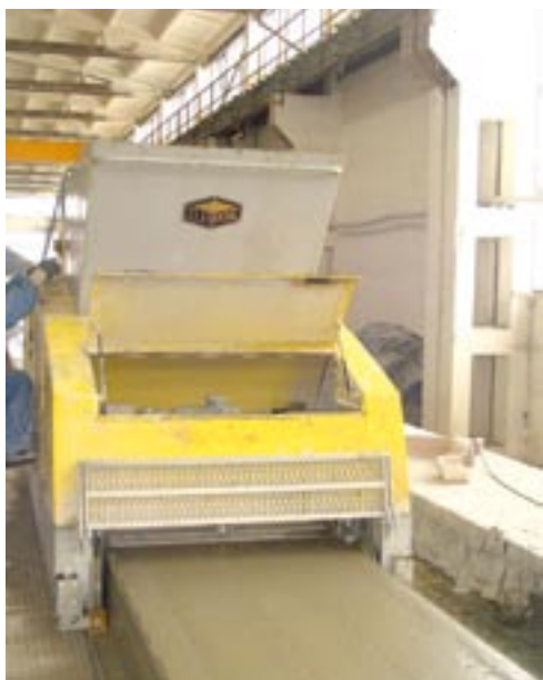
Fot. 3. Proces betonowania wstęgi betonu Źródło: opracowanie własne
