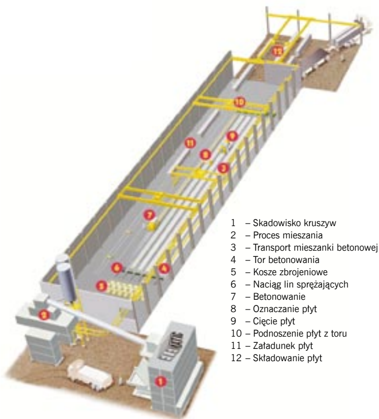
Rys. 2. Schemat procesów technologicznych sprężonych płyt kanałowych Źródło: www.elematic.com (tłum. – autor)
