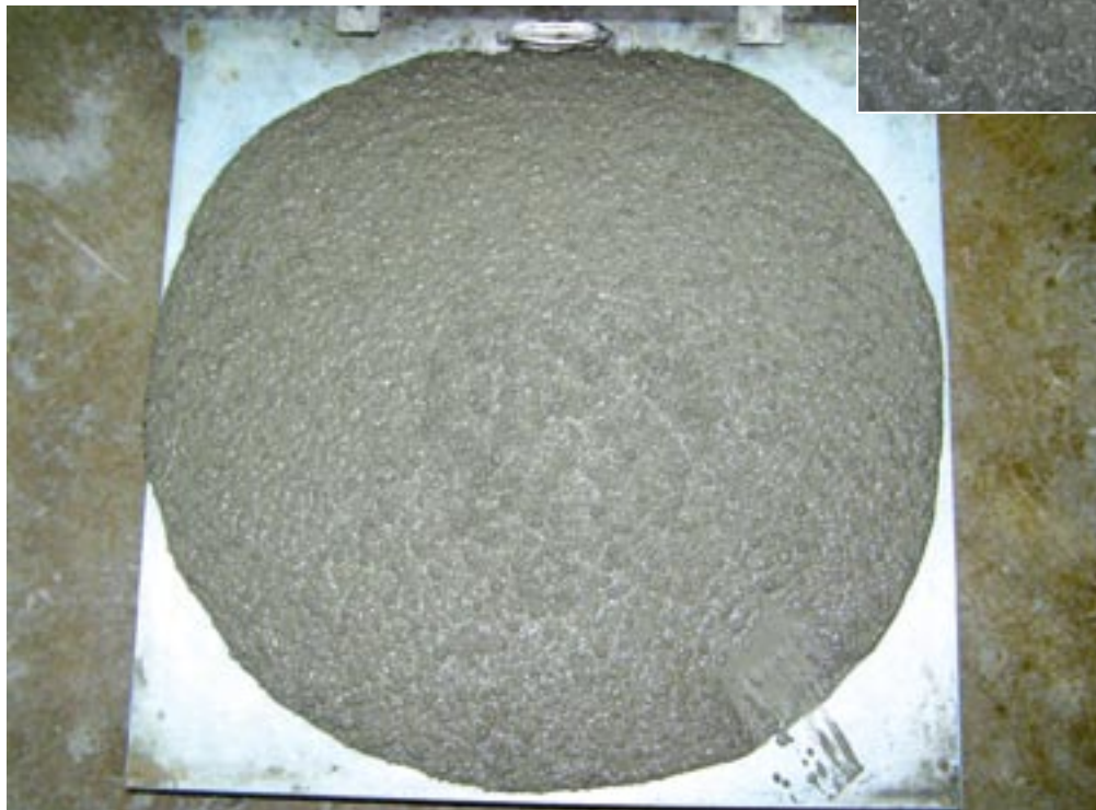
Fot. 3. Wygląd mieszanki SDC wyprodukowanej w zakładzie
