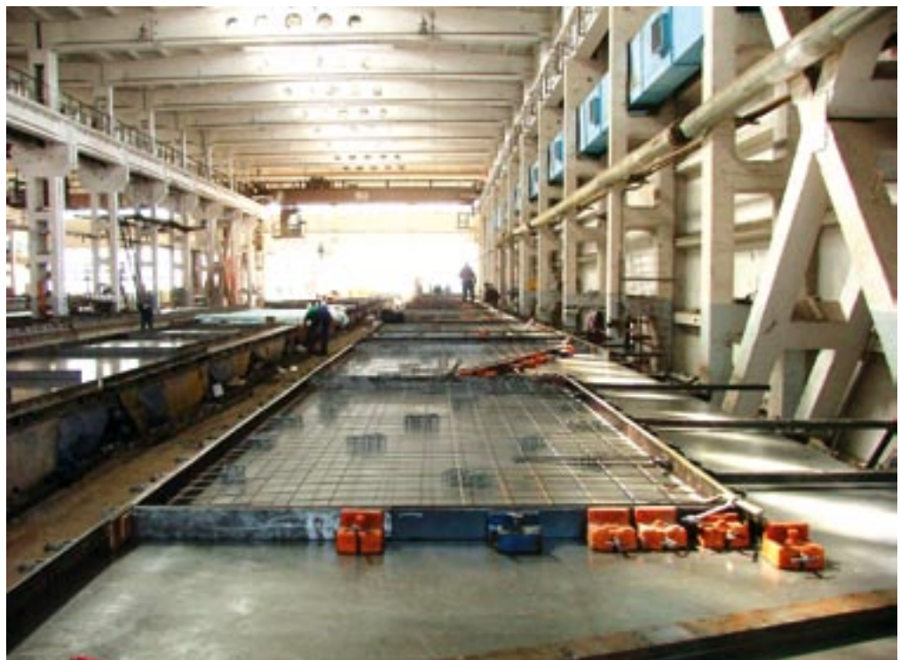
Fot. 2. Zdjęcie form produkcyjnych elementów prefabrykowanych
