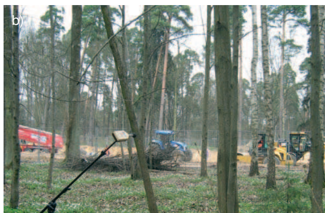
Rys. 3. Pomiary hałasu przy wykonywaniu warstwy mrozoochronnej (budowa odcinka ul. Zwierzynieckiej w Białymstoku): a) widok robót, b) pomiar w odległości 25 m od granicy robót
