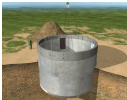
Rys. 12. Żelbetowy pierścień początkowy z nożem tnącym [1]
