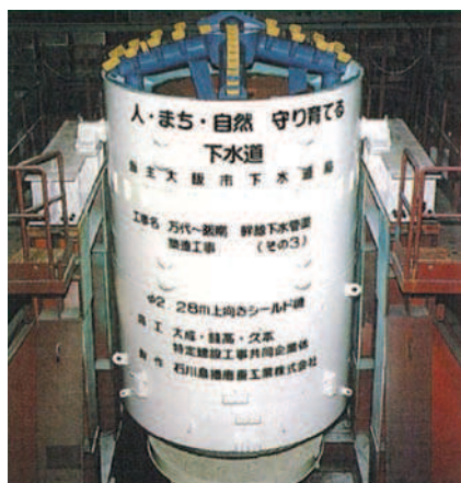
Rys. 23. Widok urządzenia w kombinacji wiercenie poziome – wiercenie pionowe do góry (Horizontal – Vertical Upward) [3]
