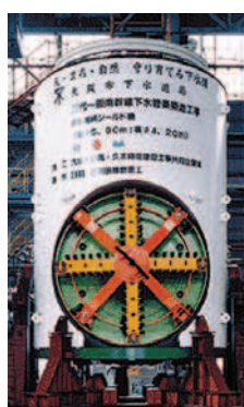
Rys. 21. Widok tarczy sferycznej przystosowanej do kombinacji wiercenia pionowo w dół – poziomo (Vertical Downward – Horizontal) [3]
