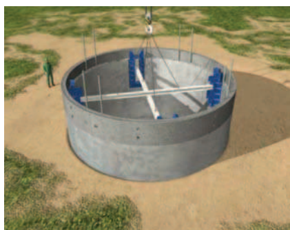
Rys. 13. Stalowe prowadnice wysięgnika urabiającego (oznaczone kolorem niebieskim) [1]
