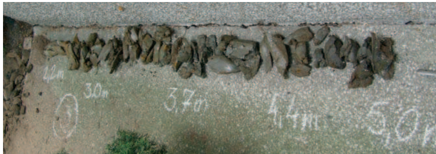
Rys. 8. Pobrany materiał badanego podłoża z odwiertu nr 3
