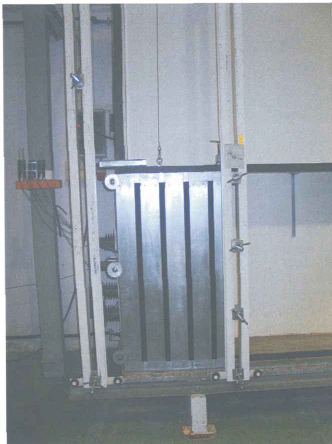
Fot. 2. Urządzenie do badania przepuszczalności powietrza i wody z taśmami uszczelniającymi, zamontowane w komorze firmy Holten Foto 2. Device to test the airtightness and watertightness with sealing tapes, mounted in Holten chamber
