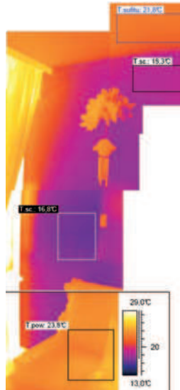
Rys. 15. Termogram, parter ściana przy szybie windowym, budynek wielkopłytkowy przy ul. Kiepury 13/32
