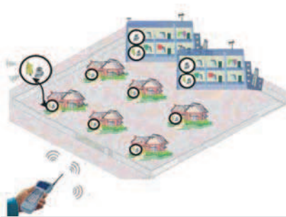
Rys. 2. Zdalny odczyt wodomierzy [2]
