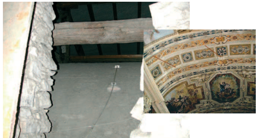
Rys. 17. Czujniki SOFO na sklepieniu nawy kościoła w Gandrii (zdjęcie autora)
