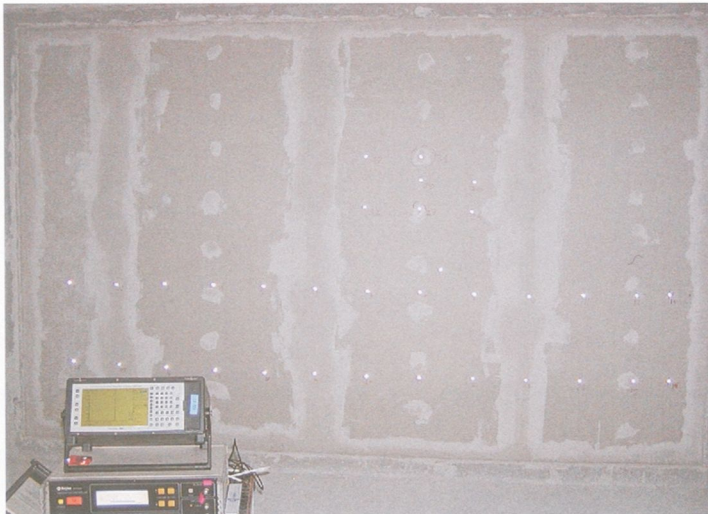
Rys. 3. Rozmieszczenie punktów do pomiaru drgań Fig. 3. Distribution of vibration measurement points over the wall surface
