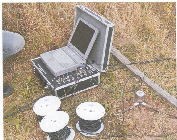
Rys. 11. Lokalizacja czujników w połowie drogi propagacji drgań wraz z aparaturą pomiarową Fig. 11. The localization of the sensors midway the vibration propagation and measuring equipment
