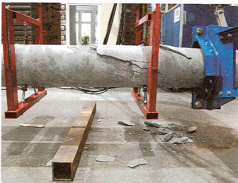
Rys. 7. Sposób i miejsce zniszczenia – badanie nr 2 Fig. 7. Manner and place of destruction of the pole – test No 2
