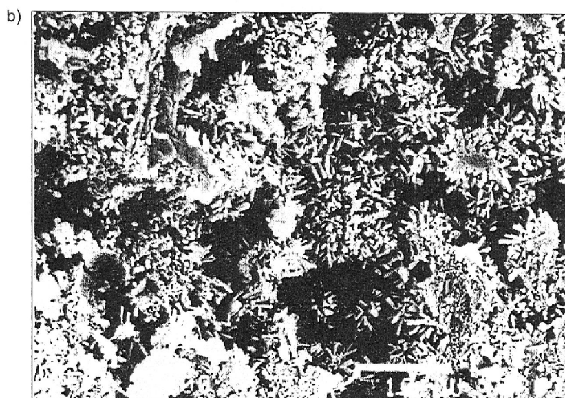
Rys. 6. Zaprawa perlitowa, seria AC, przełam, SEM: a – pow. 200x, porowate ziarno perlitu, zmienione powierzchniowo kryształami gipsu, utwory kuliste i pory powietrzne, b – pow. 200x, mikroobszar zaprawy z krystalizacją ettringitu i C-S-H oraz pory powietrzne Fig. 6. Perlite mortar, series AC, fracture, SEM: a -- magnification 200x, porous grain of perlite, surface changes of gypsum crystals, spherical objects and air pores b – magnification 200x, micro area of mortar with ettringite and C-S-H phase crystallization and air pores
