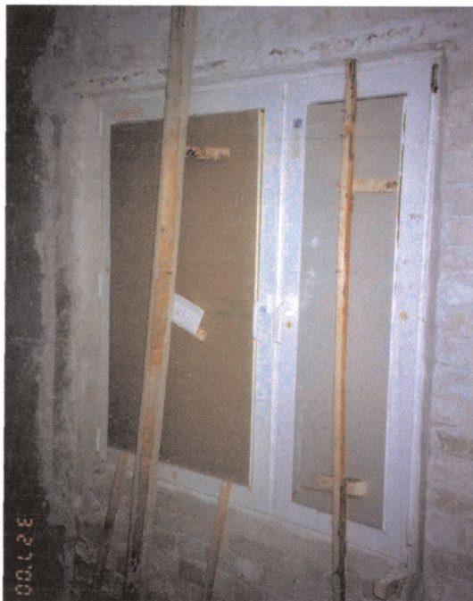
Rys. 5. Okno dwudzielne przygotowane do pomiaru izolacyjności akustycznej ramy Fig. 5. Double casement tilt window prepared for sound insulation measurements of frame
