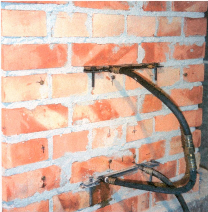
Rys. 13. Sposób osadzenia poduszek i rozmieszczenie reperków tensometru nasadowego w badaniu odkształcalności muru
