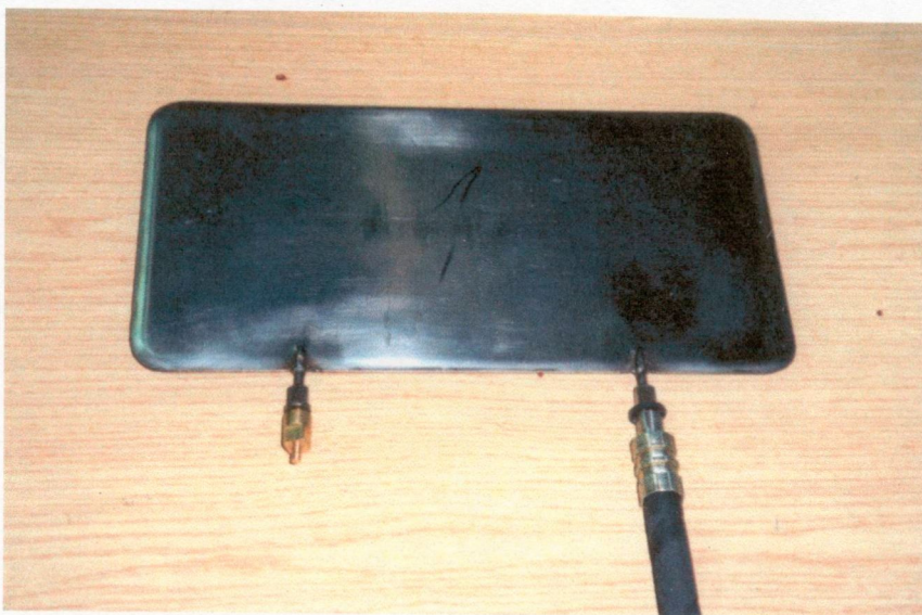
Rys. 5 . Widok poduszki ciśnieniowej Fig. 5 . View of the flatjack
