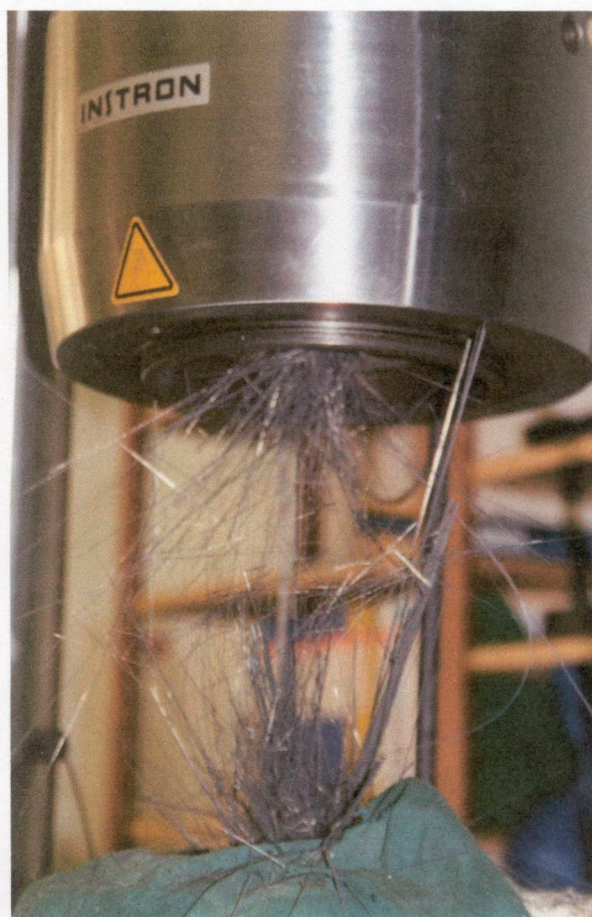
Rys. 2. Wynik próby rozciągania taśmy Fig. 2. The result of the tensile test of the CFRP plate
