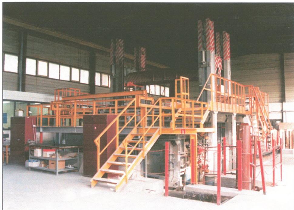
Fot. 2. Piec do badań odporności ogniowej elementów obciążonych – jesień 1987 r. Fot. 2. Furnace for fire resistance tests of loaded elements – autumn 1987 y.
