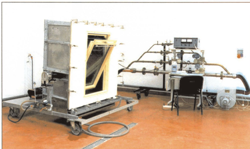
Fot. 2. Skrzynia obrotowa do badań wodoszczelności i przepuszczalności powietrza przez okna dachowe i nawiewniki z zespołem zwęzek pomiarowych strumienia powietrza Photo 2. Rotatable box for testing of watertightness and air permeability of roof windows and ventilating inlets with set of valves for measuring air flow rate
