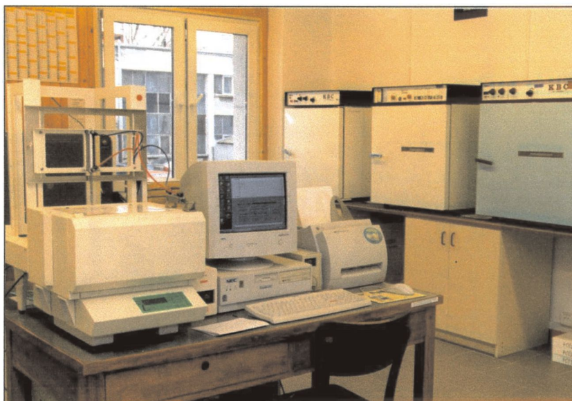
Fot. 5. Aparat płytowy według PN-ISO 8301 do badań przewodności cieplnej materiałów izolacji cieplnej Photo 5. Guarded Hot Plate apparatus (according to PN-ISO 8301) for testing thermal conductivity of thermal insulation materials
