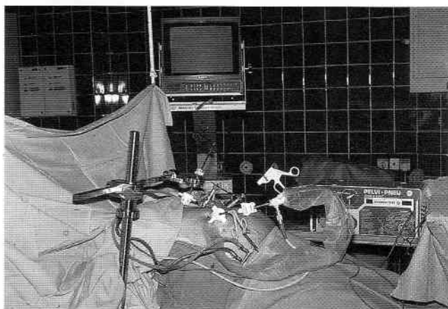
Rys. 1. Stereotaktyczny manipulator w trakcie wykonywania operacji metodą laparoskopową, wewnątrz jamy brzusznej.
