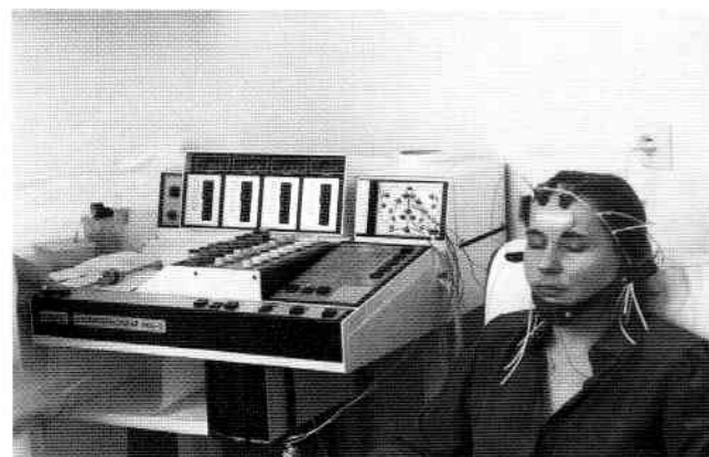
Rys. 4. Reoencefalograf REG2 opracowany w Instytucie Inżynierii Precyzyjnej i Biomedycznej Politechniki Warszawskiej.
