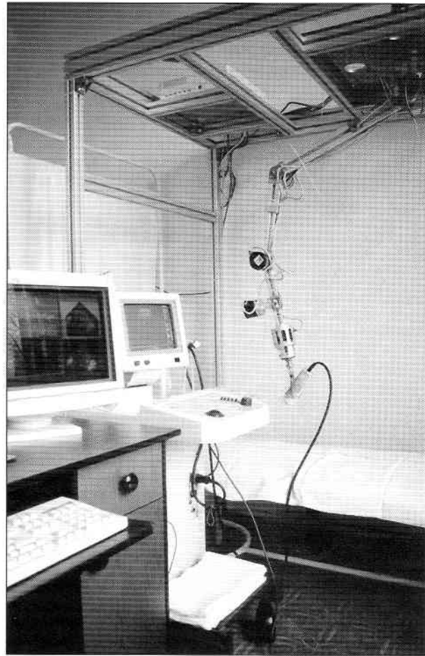
Rys. 2. Manipulator ultrasonograficzny (na konstrukcji wsporczej, w obudowie slime-line, widoczny sterownik akwizycji konfiguracji)
