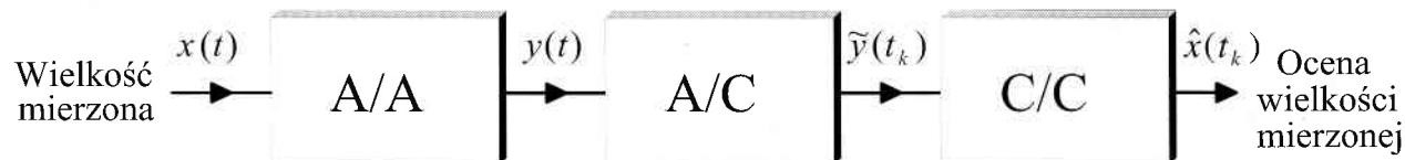
Rys. 1. Ogólna struktura przetwornika próbkującego, A/A - łańcuch przetworników analogowych, A/C - przetwornik analogowo-cyfrowy, C/C - łańcuch algorytmów przetwarzania programowego
