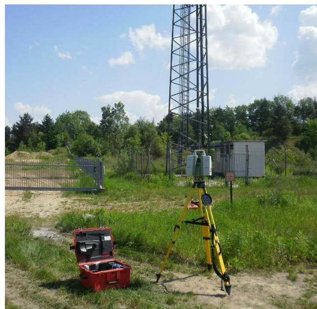
Rys. 1. Skaner laserowy Leica C10 podczas pomiaru wieży stalowej Fig. 1. Leica C10 laser scanner during steel tower measurements
