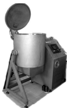
Rys. 1. Masownica mieszałowa MA150 firmy Inwestpol-Consulting Sp. z o.o. Fig. 1. Inwestpol-Consulting MA150 meat tumbler
