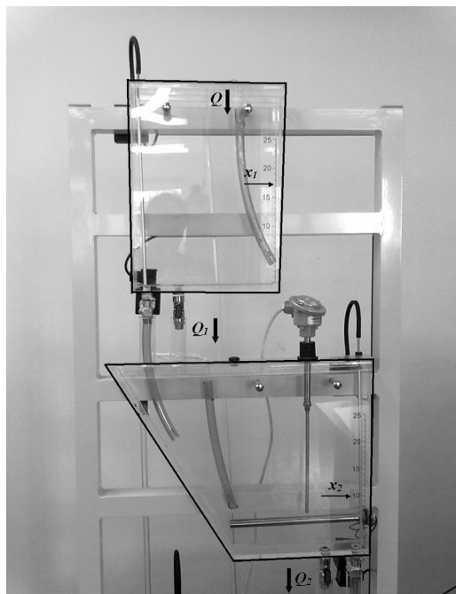
Rys. 1. Układ dwóch zbiorników Fig. 1. Two tank system
