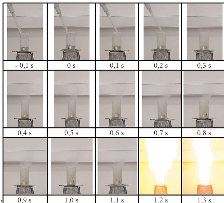
Rys. 2. Wizualizacja poszczególnych etapów procesu samozapłonu terpentyny (0,5 ml) wzbogaconej dodatkiem katalizatora ( \text{KMnO}_4 ), wywołanego przez wtrysk 88% \text{H}_2\text{O}_2 (2 ml) (autorzy)
