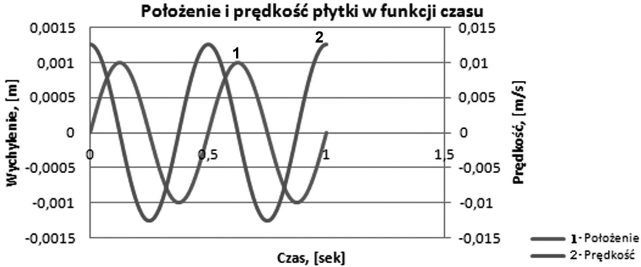
Rys. 11. Przykładowe wychylenie i prędkość płytki dla f = 2\text{Hz} i A_m = 1\text{mm}
