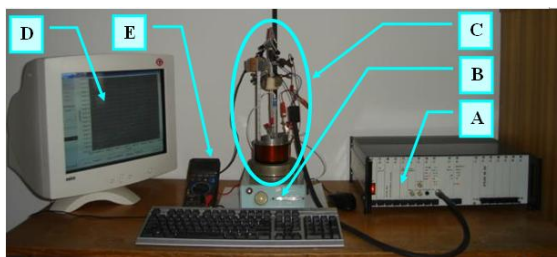
Fig. 1. Setup used for electrochemical polishing, A – potentiostat, B – heating system, C – electrochemical cell, D – computer with software, E – digital multimeter Rys. 1. Stanowisko do polerowania elektrolitycznego: A – potencjostat, B – system ogrzewania, C – elektrolizer, D – komputer z oprogramowaniem, E – multimetr cyfrowy
