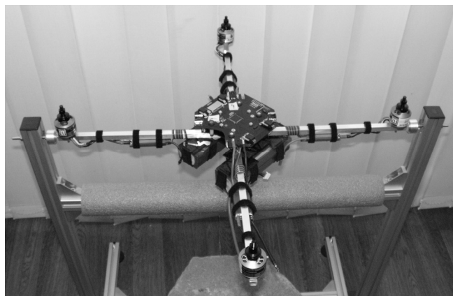
Rys. 9. Stanowisko testowe dla wielowirnikowego robota latającego Fig. 9. Testbed for the multi-rotor flying robot
