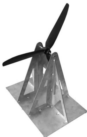
Rys. 3. Stanowisko do wyważania śmigieł Fig. 3. The station for balancing propellers
