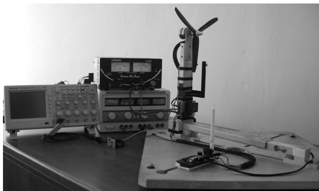
Rys. 4. Stanowisko pomiarowe Fig. 4. Thrust measurement system
