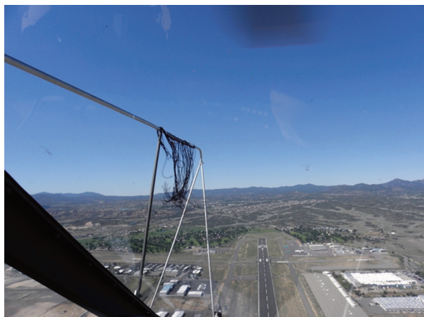
Rys. 5. Specjalny wskaźnik prędkości zerowej podczas zawisu tuż przed wyłączeniem silnika na wysokości h = 216 m (Prescott)
