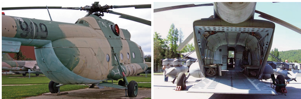
Rys. 2. Rodzaje drzwi do powierzchni ładunkowych śmigłowca Mi-8
