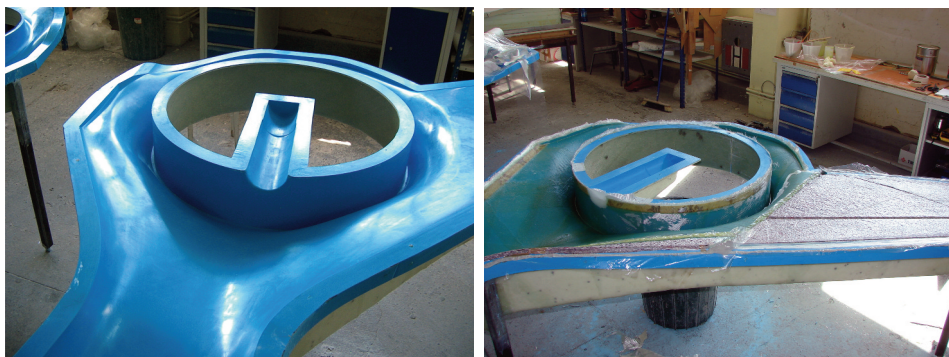
Rys. 3. Gotowy foremnik, wykonywana gotowa belka ogonowa
