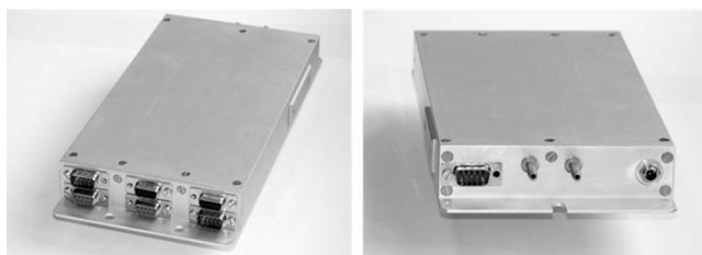
Rys. 9. Moduł pomiarowo-rejestrujący, widok od strony złączy elektrycznych i pneumatycznych
