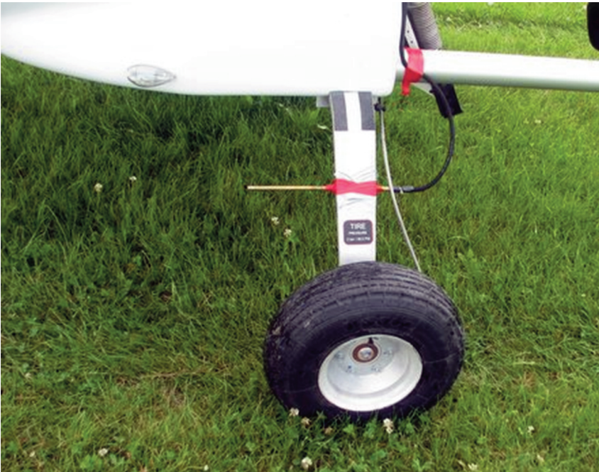
Rys. 5. Zamocowanie rurki Pitota do elementów podwozia
