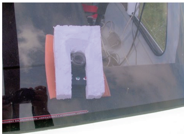
Rys. 7. Czujnik prędkości obrotowej łopat
