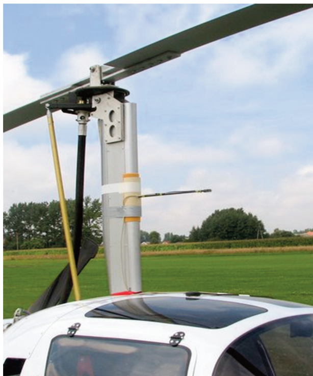
Rys.6. Zamocowanie anemometru pod wirnikiem
