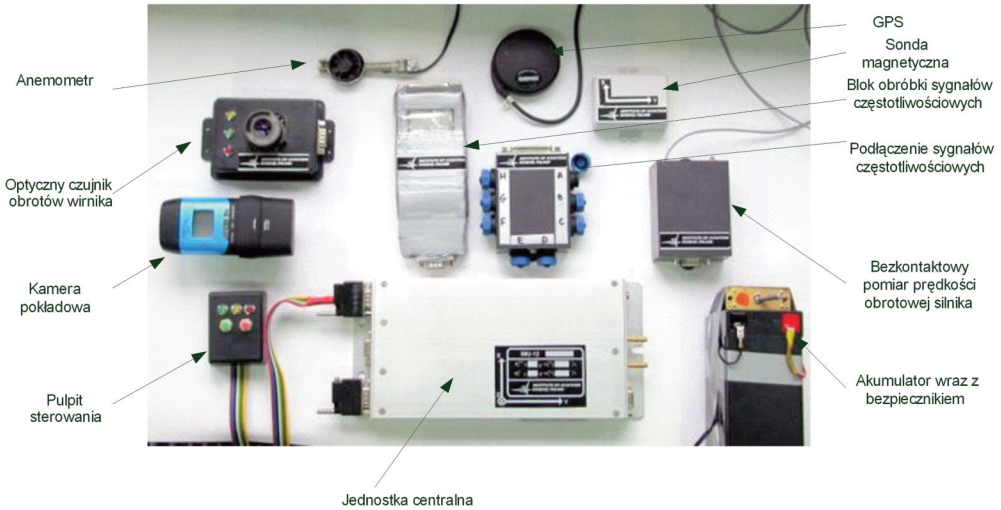
Rys. 4. Elementy systemu pomiarowo-rejestrującego
