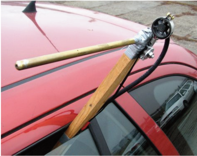
Rys. 11. Sposób zamocowania rurki Prandtla i anemometru na samochodzie
