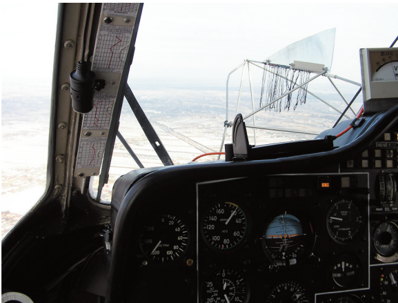
Rys. 2. Specjalny wskaźnik zamontowany przed przednią szybą służący do utrzymywania prędkości bliskiej zeru względem otaczającego powietrza
