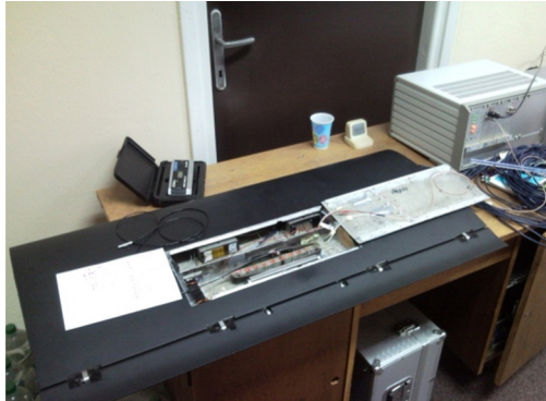
Fig. 10. Tests of CEDRAT APA piezo actuator
