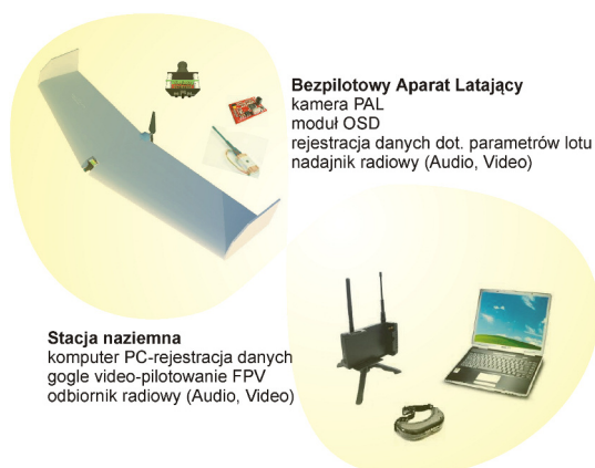
Rys. 1. Ogólna koncepcja zestawu komponentów niezbędnych do realizacji przyjętych założeń projektowych
