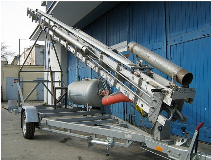
Fot. 1. Wyrzutnia WP1 z maksymalnie uniesioną belką startową (na wózku - obciążnik rurowy 25 kg)
