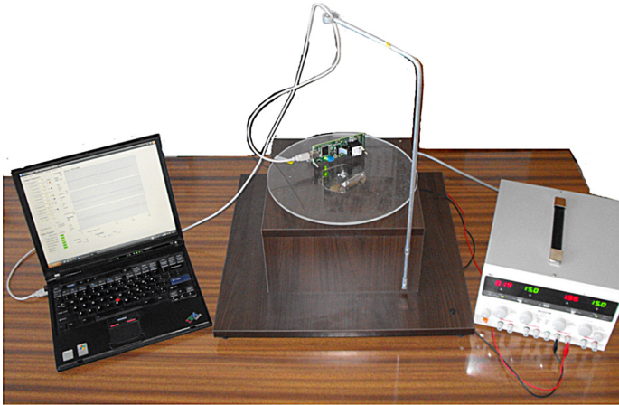
Rys. 4. Stanowisko do badań inercyjnych jednostek pomiarowych położenia
