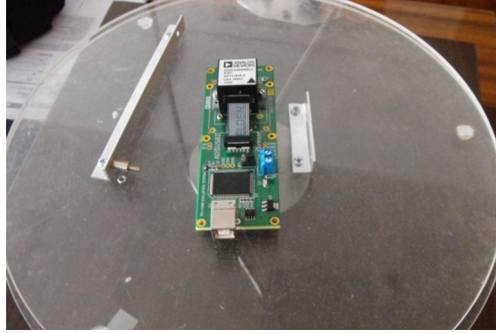
Rys. 7a. Mocowania montażowe czujnika na stole obrotowym – obrót wokół osi z
