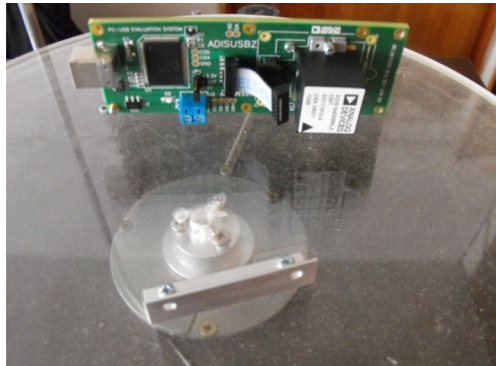
Rys. 7b. Mocowania montażowe czujnika na stole obrotowym – obrót wokół osi y
